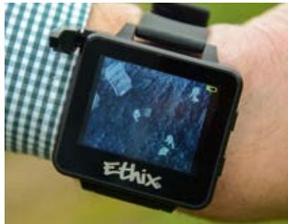
Am Boden wird das aus der Luft aufgenommene Wärmebild nicht nur auf einem größeren Bildschirm angezeigt, sondern auch auf einem kleinen am Handgelenk der Helfer.
