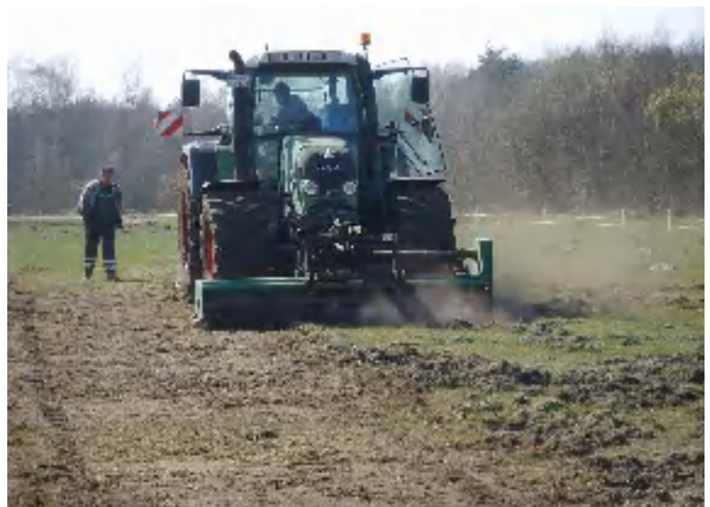
Wiesenhobel mit vorgeschalteten Mulcher zur Zerkleinerung aufgewühlter Grassoden.
